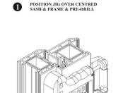
ENSURE THE ADJUSTER SLEDGDE SCREW IS FLUSH WITH THE EDGE OF THE SLEDGE
